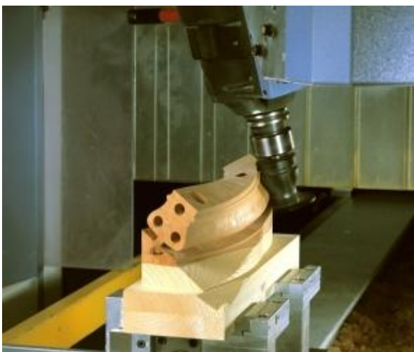
Bild 1.) - Fünf- AchsFräsvorgang Holztreppenkrümmling
